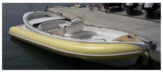
ESLORA / LENGTH 7.49 м MANGA / BEAM 3.00 м N° PERS 20 MOTOR / ENGINE MERCURY DIESEL MD 4.2 BRAVO 3 CV / HP 350 DTS COMPARTIMENTO / COMP. 7
